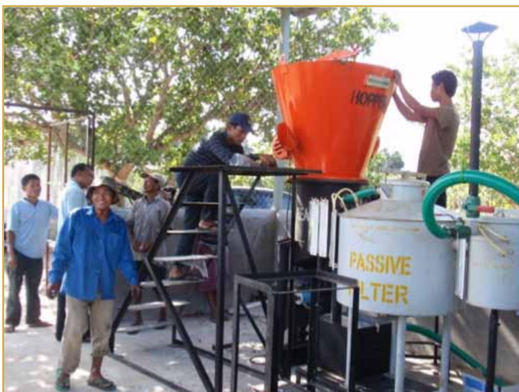
Électrification d'un village au Cambodge grâce à une unité de gazéification de résidus agricoles. © Fondem
