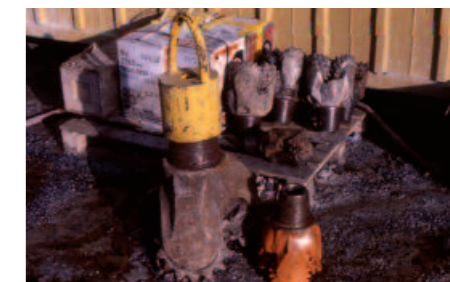
Différentes tailles et diamètres de tricônes
